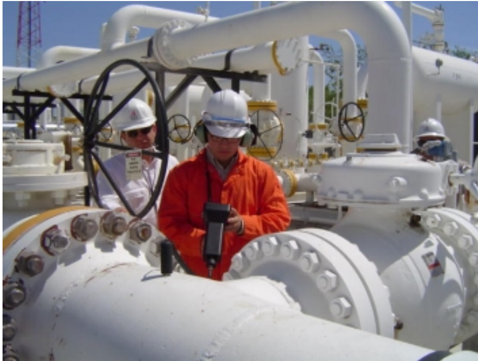
Fig. 1.1 Recolección de medición ultrasónica en punto “D” aguas abajo.
