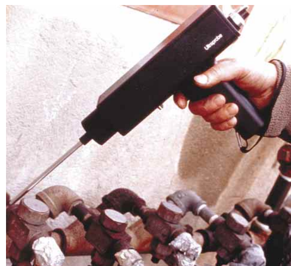
Las sondas enfocan los sonidos en un arreglo de transductores, donde se amplifica el sonido. Dependiendo de la forma y el tamaño de la parábola, el rango focal puede ser hasta 5 grados, permitiendo la localización de fugas desde distancias mayores a 35 metros.
