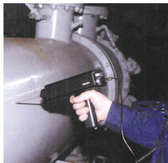
una sonda con una forma interna de "bocina" para escanear un sitio de este tipo. El débil sonido de la fuga se amplifica y llega a través de un cono recolector al transductor, permitiendo la identificación del sitio de la fuga.
