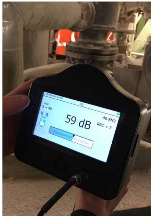
Het ultrasone signaal wordt vertaald naar laag-frequente, voor mensen hoorbare geluiden.
