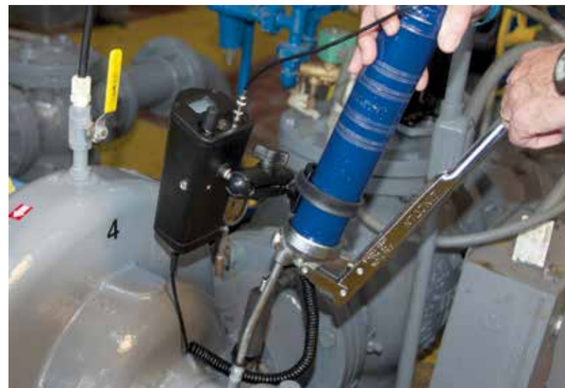
Genau die richtige Menge – also weder zu viel noch zu wenig – und das zur richtigen Zeit und ohne Kontaminationen einzubringen: Das ist das Geheimnis einer optimalen Lagerschmierung – und entsprechend aufwendig für Instandhalter in der Umsetzung. Bilder: UE Systems
