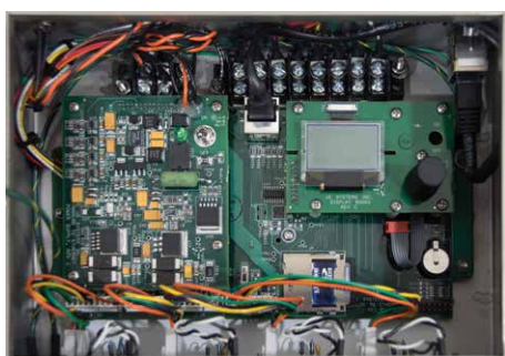
UE 4Cast: caja de circuitos abierta
