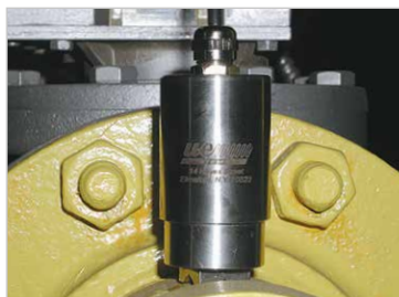
Instalación del Ultra-Trak 750™
