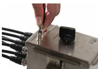
Βήμα 2 - Συνδέστε τους αισθητήρες με το κιβώτιο διανομής
