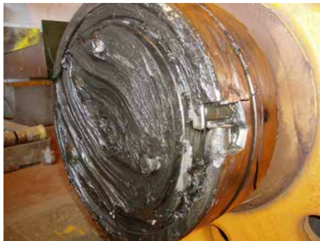
Zdjęcia uszkodzonego łożyska
