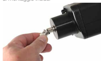
3 - Connetti la Ultraprobe al box dello switch
