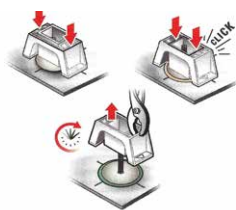
1 - Monta i sensori con i perni di montaggio inclusi
