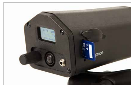
I dati della lubrificazione possono essere memorizzati sulla scheda SD
