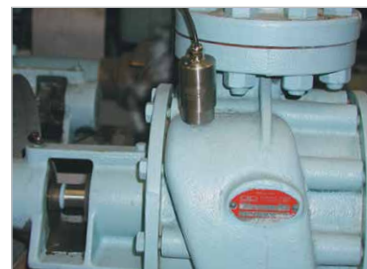
Monitoraggio di cavitazioni, cuscinetti o valvole
