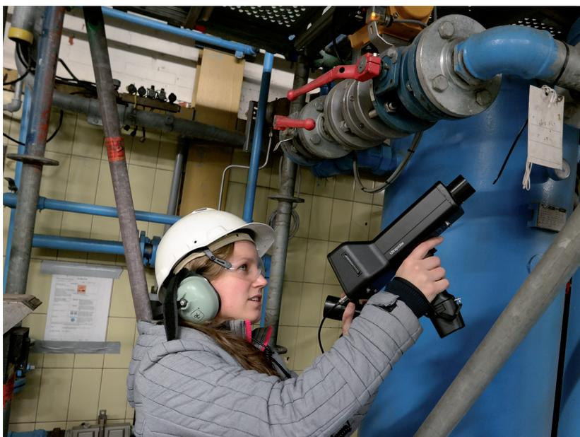
cluir que ha localizado el punto de fuga. También lo podrá determinar cuando, al hacer contacto con el módulo de confirmación de fugas en el punto exacto, la amplitud del sonido aumente notablemente y parezca que la fuga está ocurriendo dentro de sus auriculares.
