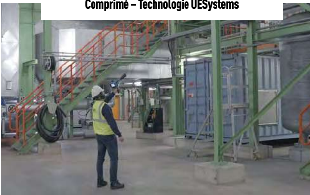
Opérations de recherche de fuites d'Azote et d'Air Comprimé – Technologie UESystems
