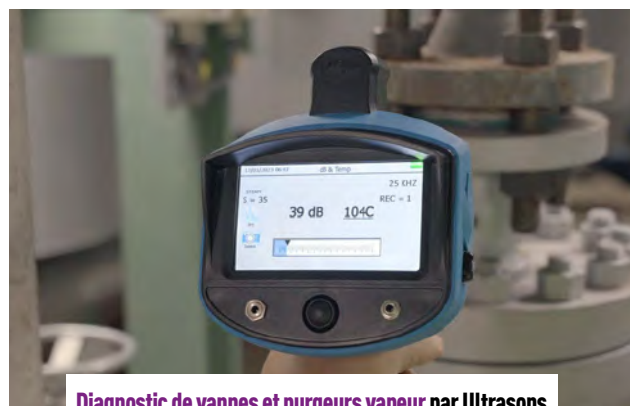
Diagnostic de vannes et purgeurs vapeur par Ultrasons en sortie de chaudière – Unité de production électrique
