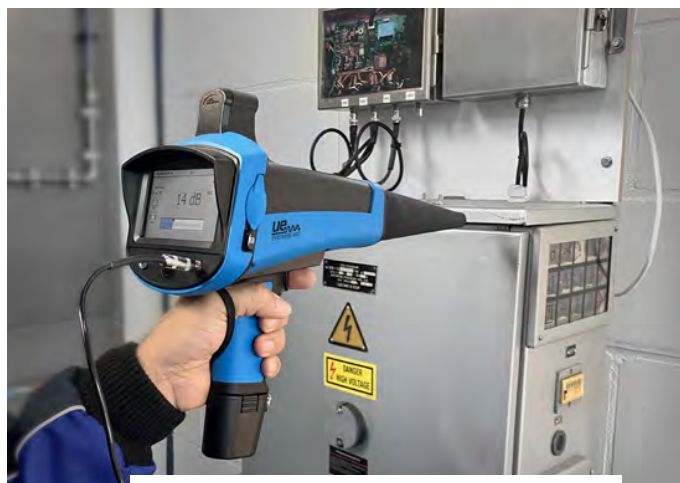
Diagnostic armoires électriques sous tension - Mise en œuvre de l'Ultrasonic 15.000 UESystems
