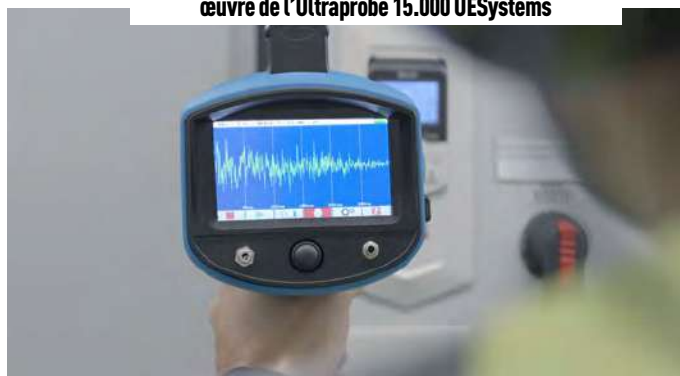
Diagnostic armoires électriques sous tension - Mise en œuvre de l'Ultrasonic 15.000 UESystems
