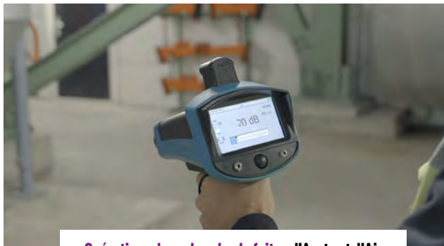
Opérations de recherche de fuites d'Azote et d'Air Comprimé – Technologie UESystems
