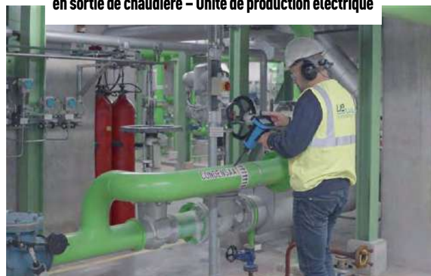
Diagnostic de vannes et purgeurs vapeur par Ultrasons en sortie de chaudière – Unité de production électrique
