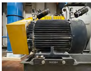
Solution de surveillance et lubrification autonome par Ultrasons : Ontrak - UESystems
