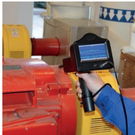
rotativos. O conceito é simples: assim que um rolamento começa a falhar ou não está lubrificado adequadamente (lubrificação insuficiente ou excessiva), os níveis de atrito aumentam. O atrito cria emissões de ultrassons, que podem ser captadas por um instrumento portátil ou sensor, e traduzidas em sons de baixa frequência que o inspetor pode ouvir. O equipamento de inspeção por ultrassons também providencia um valor de decibéis - e quanto maior esse valor de decibéis, maior o atrito.
