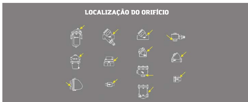
Figura 1. Localização dos pontos de contacto para a inspeção de purgadores de vapor com ultrassons.
