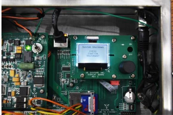
Après avoir confirmé l'arrêt, basculez l'interrupteur à bascule en position d'arrêt pour désactiver 4Cast.
