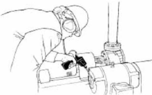
Ультразвуковые методы обследования и мониторинга подшипников являются наиболее точными при определении дефектов на ранних стадиях. Ультразвуковые методы диагностики позволяют получить предупреждение о возможном дефекте подшипникового узла до того, как появится его перегрев или возникнут низкочастотные вибрации. Ультразвуковое обследование способно определить:
