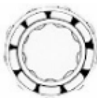
Недостаточно смазки Увеличение амплитуды сигнала
