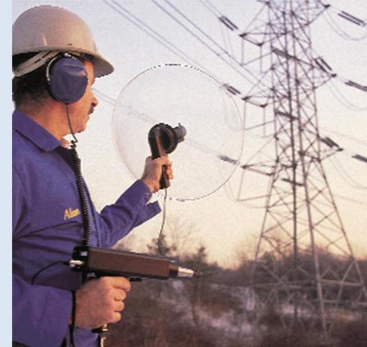
Cela s'applique à tout type d'équipement et peut être détecté à une distance de plus de 30 mètres à l'aide d'un module parabolique,
