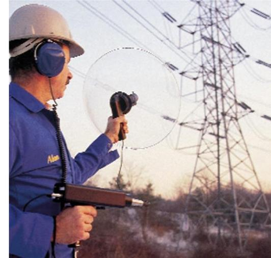
Cela s'applique à tout type d'équipement et peut être détecté à une distance de plus de 30 mètres à l'aide d'une parabole.
