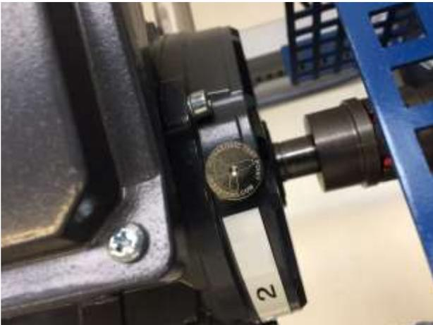
Module de contact aimanté pour rondes d'inspections :
